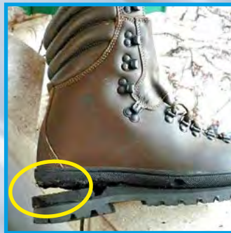
INCOLLAGGI FLESSIBILI E SOTTOPOSTI A TORSIONI
